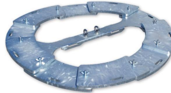
Punto di ancoraggio a peso morto dal design rivoluzionario. Composto da 10 contrappesi da 25 kg l'uno, più una piastra base con due anelli di ancoraggio girevoli. Ideale su coperture con inclinazione fino a 5°.
