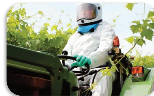
Elettro respiratori con casco a ventilazione assistita
